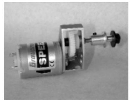
*Qui sopra, due riduttori monostadio. A sinistra, un Graupner 1,85:1 al quale sono state asportate le alette di montaggio per ridurre l'ingombro. A destra un G&G 2:1 montato su uno Speed 280. Qui sotto, un riduttore a due stadi della Jastron (Rep. Ceca). Il forte rapporto di riduzione (6:1), ha costretto ad aumentarne il diametro rispetto a quello del motore in modo da poter alloggiare l'ingranaggio principale.*
