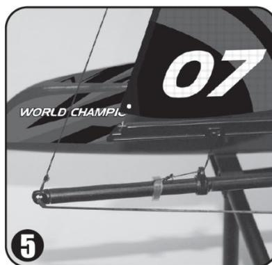
6. Führen Sie das Seil des Fockauslegers durch die zweite Öse des Auslegers (von der Vorderseite zurück zur Rückseite), die sich im mittleren Holm befindet, fädeln Sie es durch die Öse des Beplankungsdecks am vorderen Querträger und befestigen Sie die Seilschleufe am Stift.
